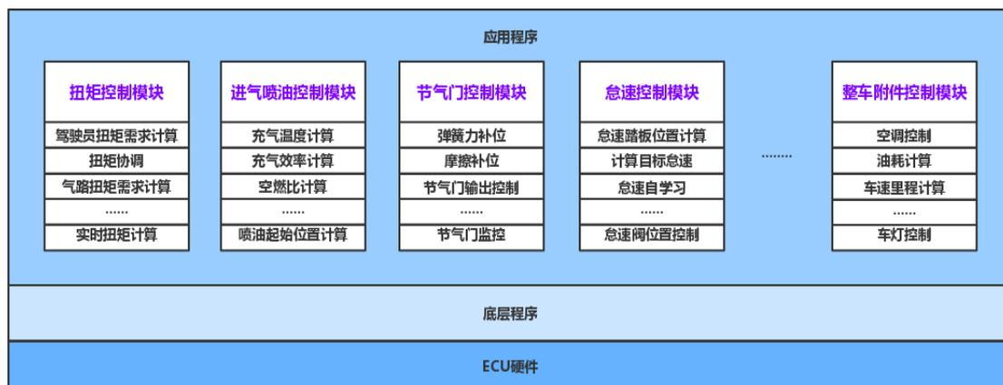
其中，底层程序是指与硬件密切相关的软件，具体包括用于输入和输出的软件驱动、微控制器驱动、存储驱动、通信驱动等。底层程序的通用性在于只有硬件发生变化才会增加或改变相应底层程序。例如，从轻型汽车国五平台升级到国六平台时由于增加了 GPF、宽域氧传感器、以及与蒸发排放、节温诊断、油箱泄露诊断相关的传感器，因此在底层程序中需要增加相应的硬件驱动程序。
